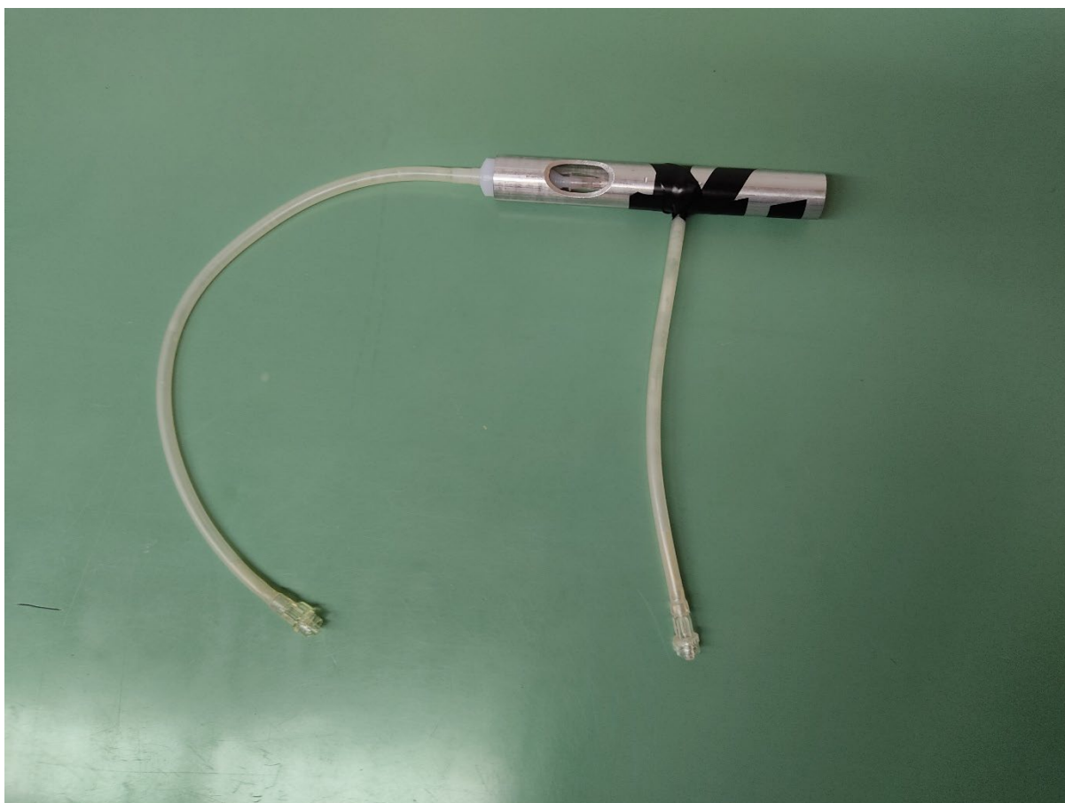
Slika 2: Sestavljena naprava za izvedbo eksperimenta. Odjem statičnega tlaka na drugi luknjici z leve. Tlačni senzorji niso priklopljeni.
