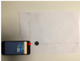
Slika 1: Merjenje magnetnega polja 2. magneta v x smeri. Z rdečo piko je označeno mesto vgrajenega merilnika.
