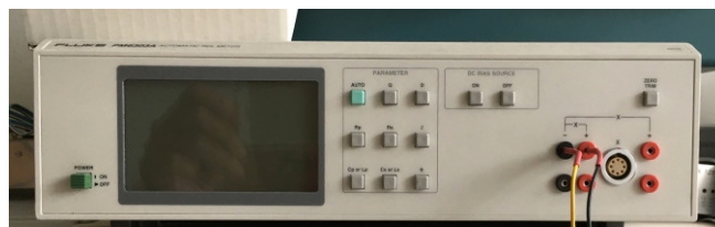
sl.6. Instrument, ki meri kompleksne upornosti
