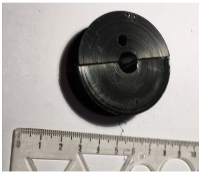
Sl.9. Izstružimo PVC v takole obliko in prežagamo po premeru
