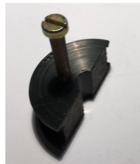
Sl.10. Tuljavnik za D tuljavo opremimo z držalom, da lažje navijemo 150 do 200 ovojev
