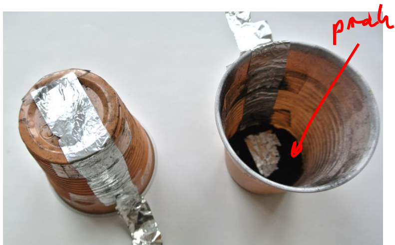
Slika 8: Tako sestavimo model ogljenega mikrofona
