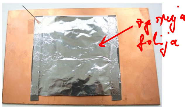
Slika 6b: Tako naredimo model kondenzatorskega mikrofona
