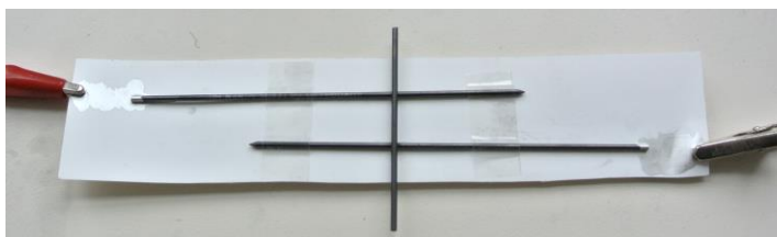
Slika 9: Zelo enostaven ogljeni mikrofonski aparat z vložki za tehniški svinčnik
