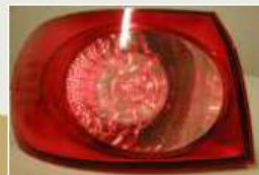
Brems- / Rücklicht- Funktion 2000
