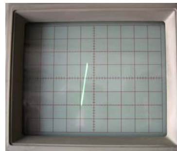
Slika 4: Slika geometrično seštetih induciranih napetosti na zaslonu xy – osciloskopa, navadno izmenično magnetno polje
