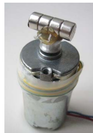
Slika 5: Tako naredimo vrtilno magnetno polje s stalnimi magneti
