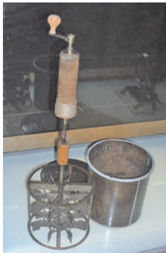
Slika 13: Naprava, s katero je Joule prvič ocenil mehanični ekvivalent toplote.
