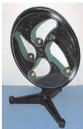
Slika 5: Načrt za perpetuum mobile: neuravnovešeno kolo s kroglastimi utežmi v utorih.
