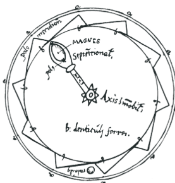
Slika 3: Načrt za perpetuum mobile z magneti Pierra Maricourta okoli leta 1260.
