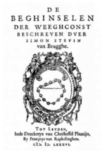
Slika 9: Simon Stevin je s privzetkom, da perpetuum mobile ni mogoč, obravnaval ravnovesje na klancu. Misel se mu je zdela tako posrečena, da je risbo dal na naslovnico svoje knjige.
