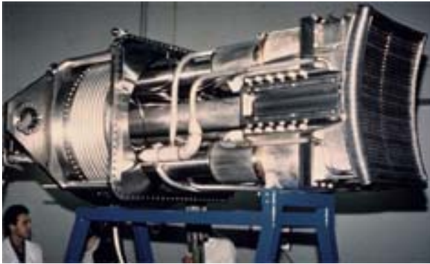
Antena za oddajanje elm. valov pri ionski ciklotronski frekvenci na JET-u, frekvenčno območje od 20 do 55 MHz
