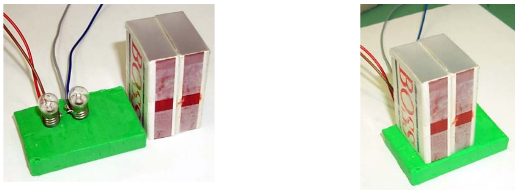
Sl.6. Kako zgradimo fotometer BOSS? Na dve žarnici prispajkamo dovodne žice. Žarnici vsadimo v gredico plastilina. Snamemo ohišji dveh vžigalčnih škatlic in ju opremimo z okencema iz prosojnega lepilnega traku. Obe ohišji povežemo z lepilnim trakom in ju posadimo prek obeh žarnic.
