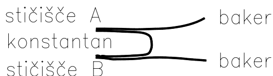
Sl.3. Dve bakreni žici in žica iz konstantana sestavljajo termočlen. Med bakrenima žicama dobimo napetost, sorazmerno temperaturni razliki med točkama A in B. Napetost je majhna, le 43 \cdot 10^{-6} V na stopinjo Kelvina
