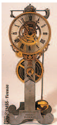
Slika 1: Model ure na nihalo naj bi naredili po Galilejevem predlogu iz leta 1641.
